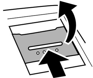
Klappen Sie den Deckel nach oben in eine senkrechte Position. Legen Sie die Karte in das Fach ein. Achten Sie darauf, dass die Kontakte nach unten zeigen und die abgechrägte Kante entsprechend der Abbildung eingesetzt wird. Halten Sie die Karte in der korrekten Ausrichtung und schließen Sie den Deckel.
